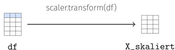
Der `MinMaxScaler` normalisiert die Daten und schreibt die normalisierten Daten in ein NumPy Array. Dabei gehen die Informationen darüber, welche Spalte welchen Namen hat, verloren. Bei der Normalisierung werden allerdings auch keine neuen Spalten erzeugt und die Spalten im NumPy Array werden in der gleichen Reihenfolge angelegt, wie im ursprünglichen DataFrame.
